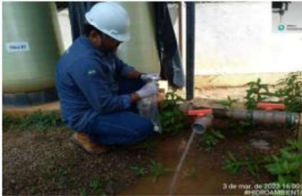
FOTO 03: Coleta de Água Caixa D Água pos filtragem.
