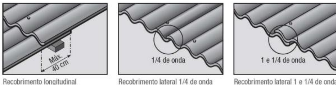
Imagem 02 – Recobrimento de telhas onduladas de fibrocimento
