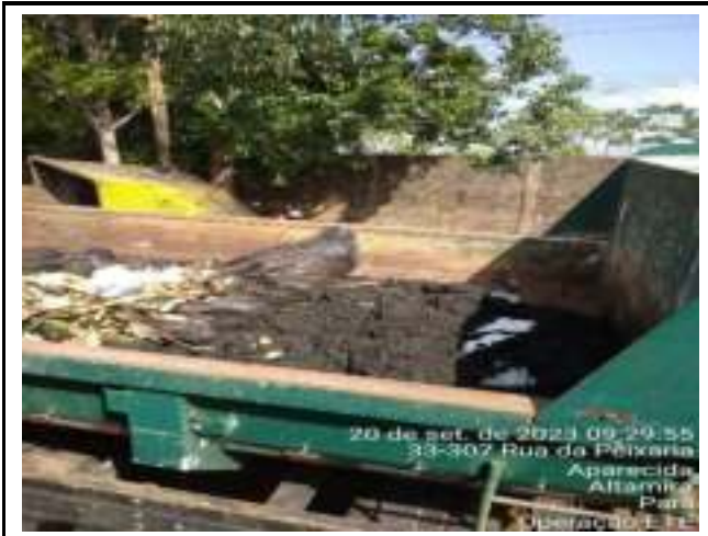
FORAM CENTRIFUGADOS 16 METROS CÚBICOS DE LODO RETIRADO DO TANQUE DECANTADOR SECUNDÁRIO
