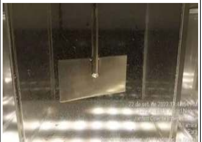
ENSAIO DE FLOCULAÇÃO COM USO DE APARELHO JAR-TEST DA DOSAGEM DO PAC
