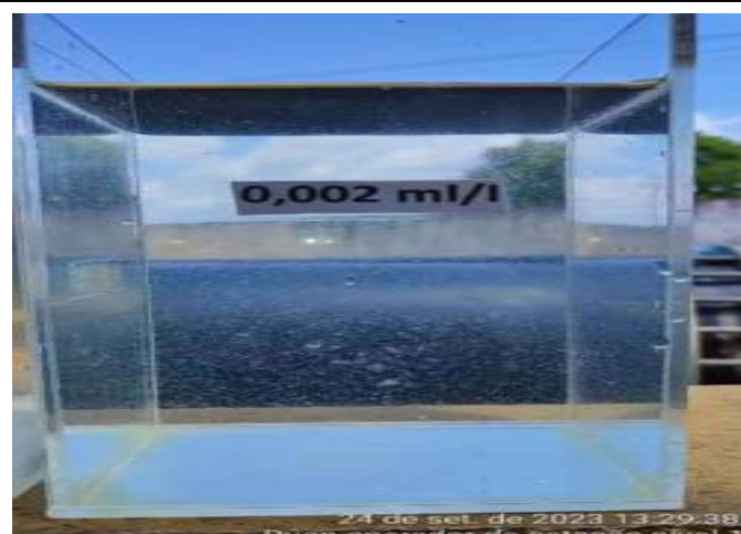
TESTES COMPARATIVOS DE FLOCULAÇÃO REALIZADOS COM E SEM POLÍMERO, RESPECTIVAMENTE
