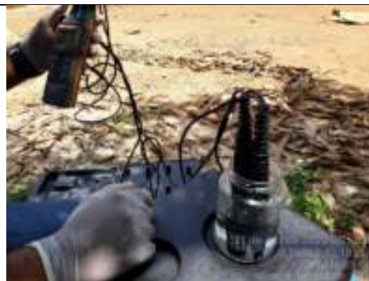
Foto 92: Análise de PH, temperatura, oxigênio dissolvido e Condutividade.
