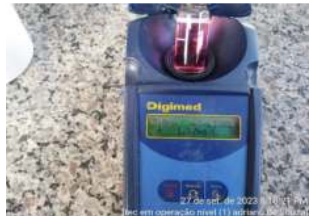
CONTROLE DO CLORO DO RAP 08
