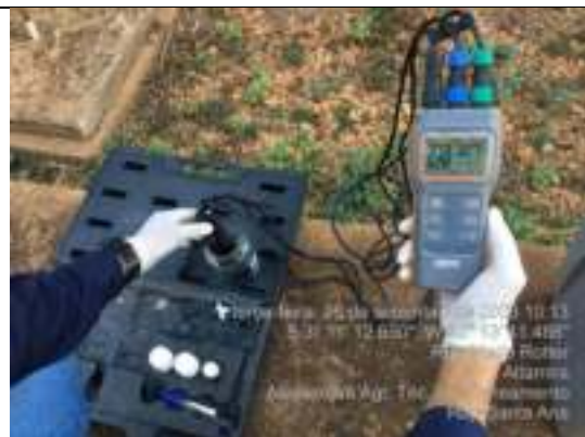
Foto 63: Análise de PH, temperatura, oxigênio dissolvido e Condutividade.
