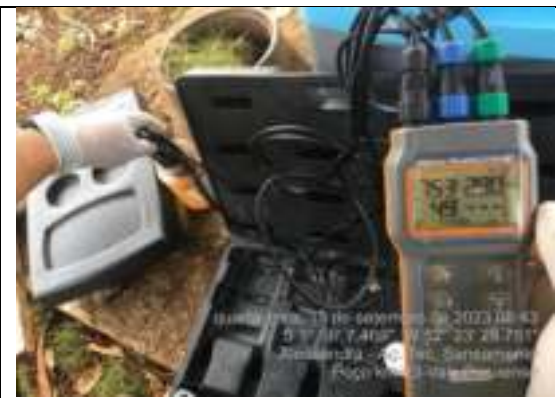
Foto 04: Análise de PH, temperatura, oxigênio dissolvido e Condutividade.
