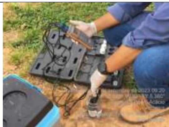
Foto 81: Análise de PH, temperatura, oxigênio dissolvido e Condutividade.
