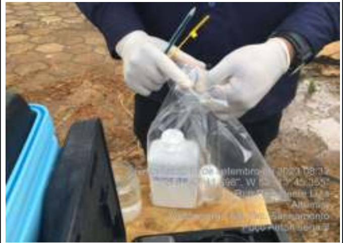
COLETA DE AMOSTRAS DE POÇOS DE DISTRIBUIÇÃO DE ÁGUA DA ZONA URBANA PARA ANÁLISE DOS PARÂMETROS DE QUALIDADE
