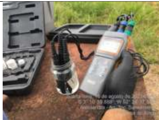
Foto 4: Análise de PH, temperatura, oxigênio dissolvido e Condutividade.
