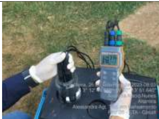
Foto 45: Análise de PH, temperatura, oxigênio dissolvido e Condutividade.
