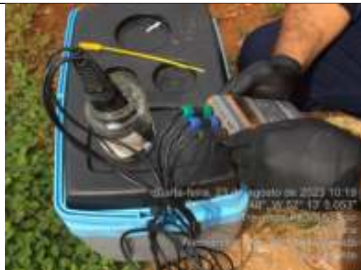
Foto 68: Análise de PH, temperatura, oxigênio dissolvido e Condutividade.
