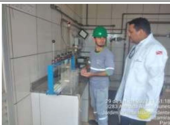
TREINAMENTO REALIZADO COM OS OPERADORES DA ETA VOLTADO A ENSAIOS DE FLOCULAÇÃO NO APARELHO JAR TEST
