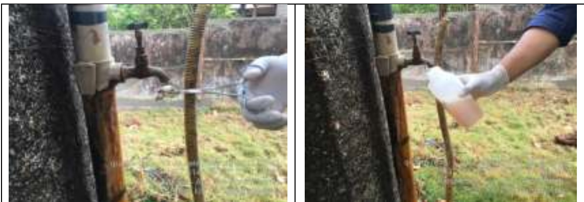
Foto 01: Esterilização com fogo – torneira de metal
