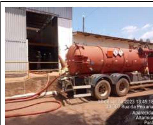
SUCÇÃO DO LODO DO MISTURADOR DA CENTRÍFUGA
