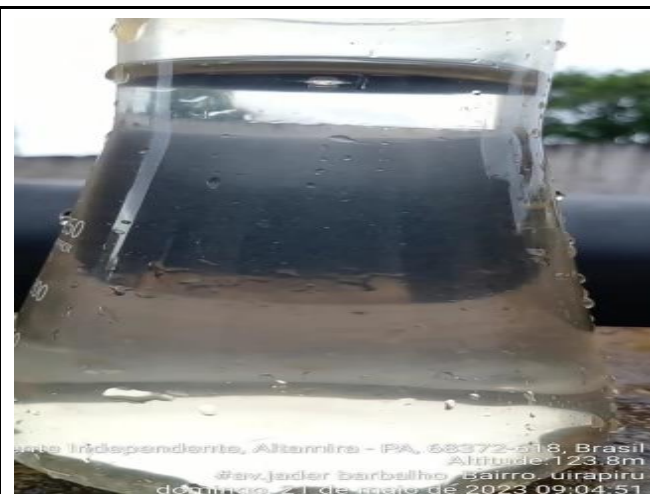
ENSAIO DE FLOCULAÇÃO COM USO DE APARELHO JAR-TEST DA DOSAGEM DO PAC
