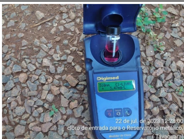
ANÁLISE DE CLORO RESIDUAL LIVRE DA ENTRADA E SAÍDA DO RESERVATÓRIO METÁLICO DO RUC TAVAQUARA
