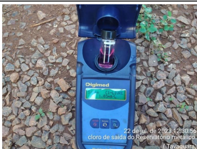
ANÁLISE DE CLORO RESIDUAL LIVRE DA ENTRADA E SAÍDA DO RESERVATÓRIO METÁLICO DO RUC TAVAQUARA
