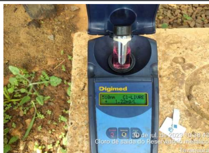
ANÁLISE DE CLORO RESIDUAL LIVRE DA SAÍDA DO RESERVATÓRIO METÁLICO DO RUC TAVAQUARA
