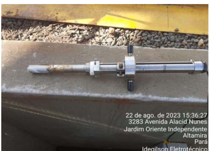
RETIRADA DA SONDA DO MEDIDOR DE VAZÃO NETA PARA REALIZAÇÃO DE LIMPEZA
