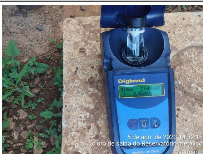
MANOBRA PARA DOSAGEM DE CLORO, DEVIDO AO BAIXO TEOR DE CLORO RESIDUAL LIVRE DETECTADO
