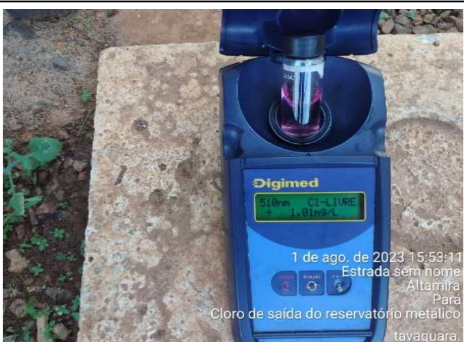
ANÁLISE DE CLORO RESIDUAL LIVRE DA SAÍDA DO RESERVATÓRIO METÁLICO DO RUC TAVAQUARA
