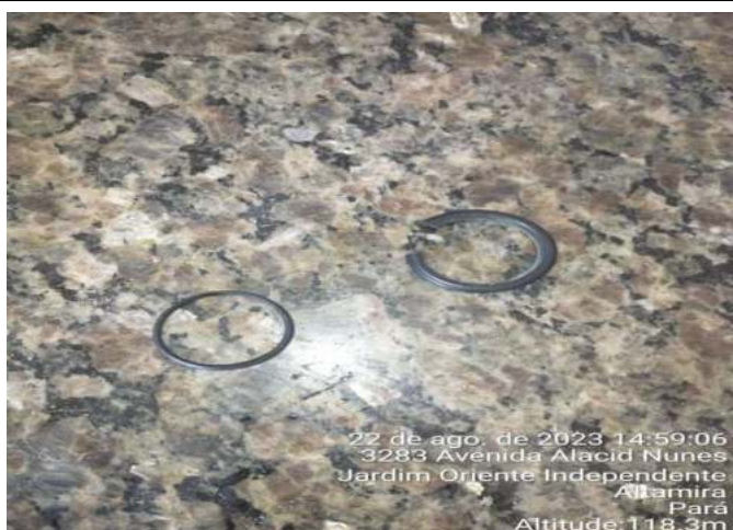
SUBSTITUIÇÃO DAS BORRACHAS DE VEDAÇÃO DAS LUVAS DE UNIÃO DA REDE DE DOSAGEM DE CLORO DA ÁGUA TRATADA
