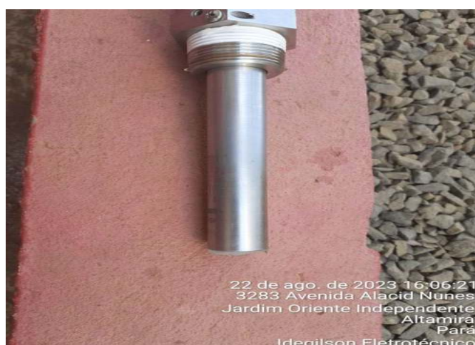
RETIRADA DA SONDA DO MEDIDOR DE VAZÃO NETA PARA REALIZAÇÃO DE LIMPEZA
