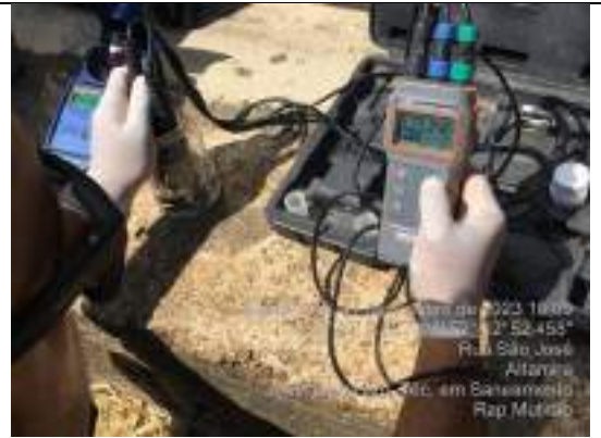
Foto 50: Análise de PH, temperatura, oxigênio dissolvido e Condutividade.
