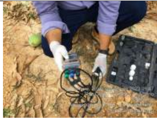
Foto 74: Análise de PH, temperatura, oxigênio dissolvido e Condutividade.
