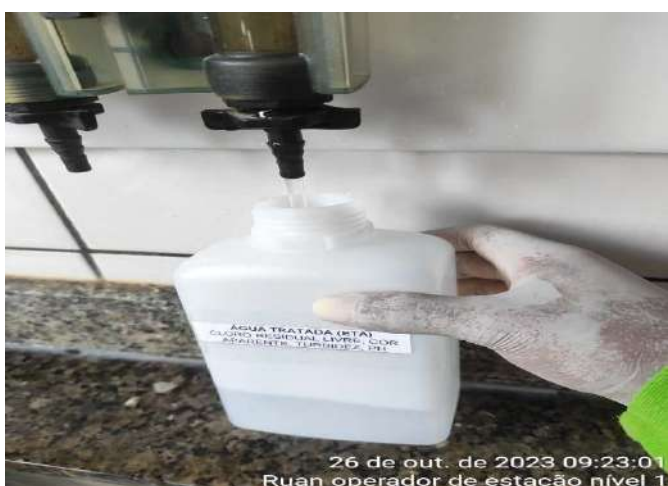
COLETA DE AMOSTRAS DA ETA MODULAR PARA ENCAMINHAMENTO À MULTIANÁLISES
