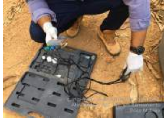
Foto 68: Análise de PH, temperatura, oxigênio dissolvido e Condutividade.
