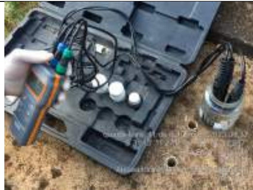
Foto 20: Análise de PH, temperatura, oxigênio dissolvido e Condutividade.
