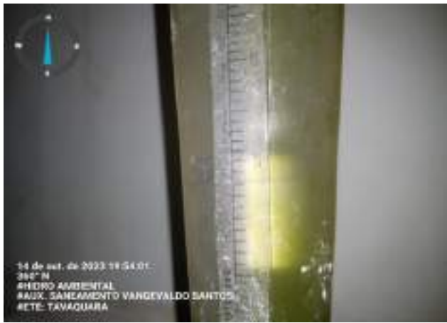
VERIFICAÇÃO DOS ROTÂMENTOS
