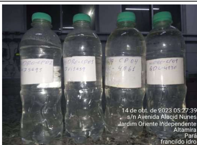
COLETA DE AMOSTRAS DA ÁGUA DISTRIBUÍDA POR CAMINHÕES PIPA PARA ANÁLISE DE PARÂMETROS DE QUALIDADE
