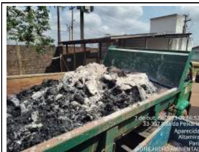
CENTRIFUGADO E LAVADO PARA O ATERRO 8 KLS DE LODO
