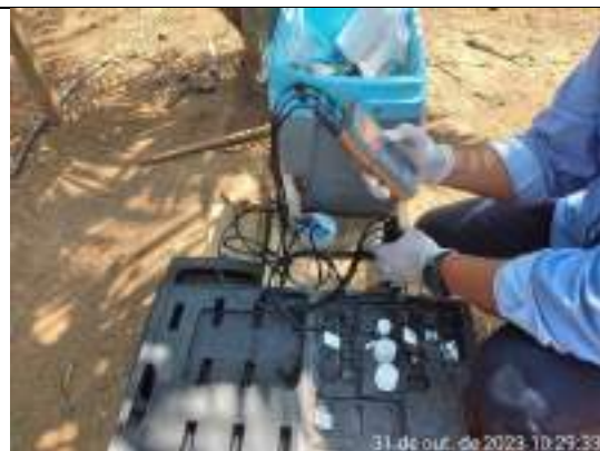
Foto 92: Análise de PH, temperatura, oxigênio dissolvido e Condutividade.
