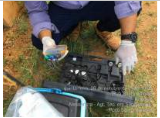
Foto 80: Análise de PH, temperatura, oxigênio dissolvido e Condutividade.
