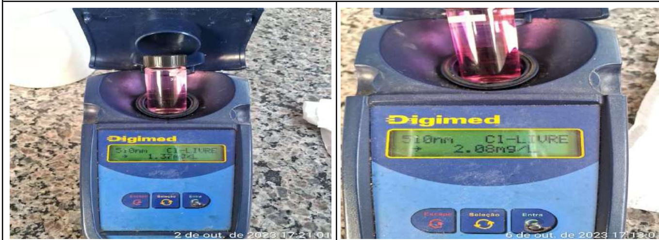
ANÁLISE DOS PARÂMETROS DE TURBIDEZ, CLORO E PH DO RAP 8
