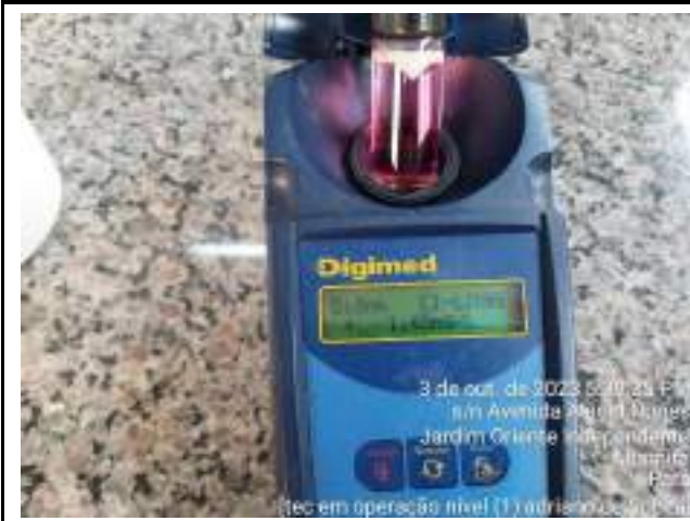
CONTROLE DO CLORO RAP 08
