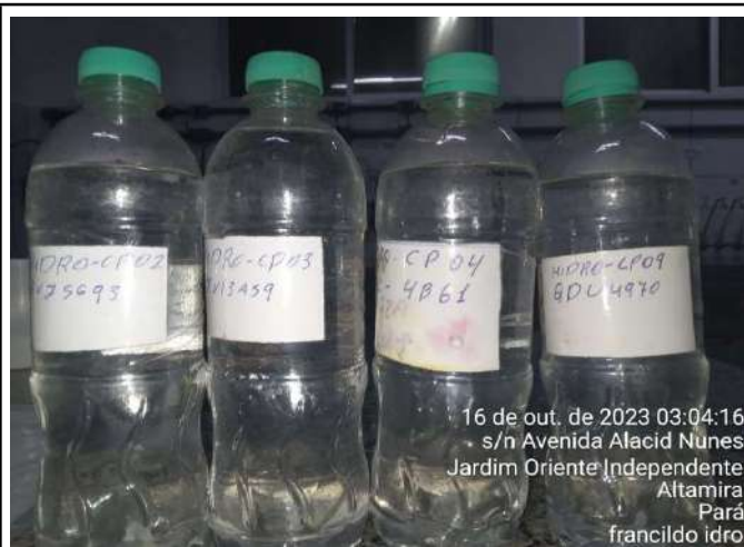
COLETA DE AMOSTRAS DA ÁGUA DISTRIBUÍDA POR CAMINHÕES PIPA PARA ANÁLISE DE PARÂMETROS DE QUALIDADE
