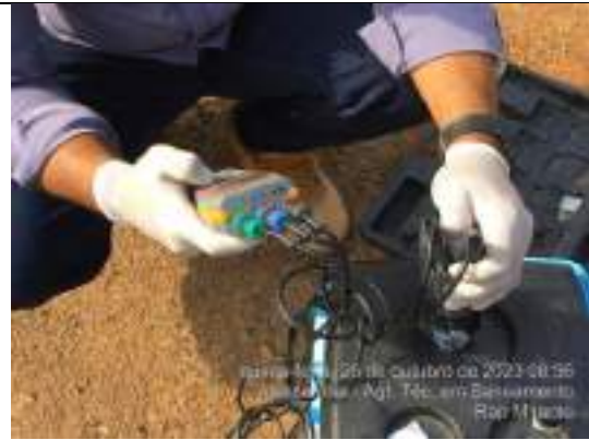
Foto 62: Análise de PH, temperatura, oxigênio dissolvido e Condutividade.
