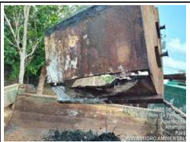
CAÇAMBAS UTILIZADAS NAS ATIVIDADES DE CENTRIFUGAÇÃO DE LODO E DESCARTE DE AREIA DOS KOMBIS ESTÃO APRESENTANDO RISCO PARA AS ATIVIDADES DEVIDO ESTAREM BASTANTE DANIFICADAS.
