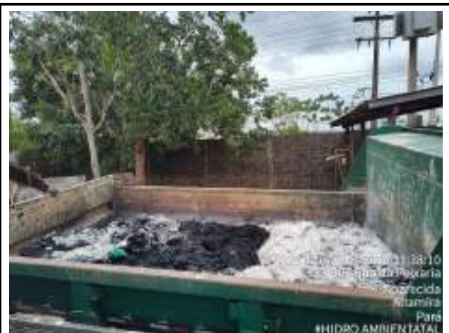
CENTRIFUGADOS 6 m 3 DE LODO LINHA B
