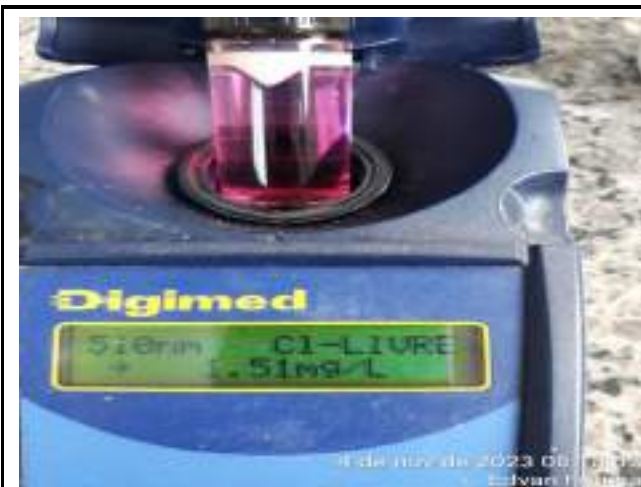
MONITORAMENTO DO CLORO RAP 8
