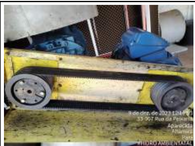
DESMONTAGEM DO SOPRADOR 3 PARA TROCA DE CORREIAS
