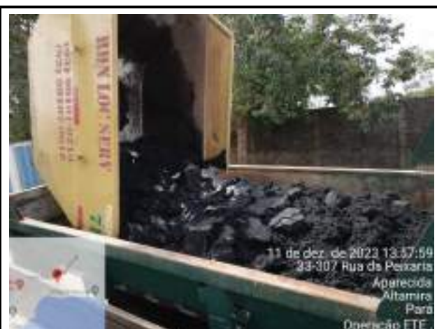
CENTRIFUGADO 23 m 3 DE LODO
