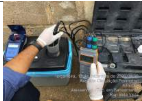
Foto 22: Análise de PH, temperatura, oxigênio dissolvido e Condutividade.
