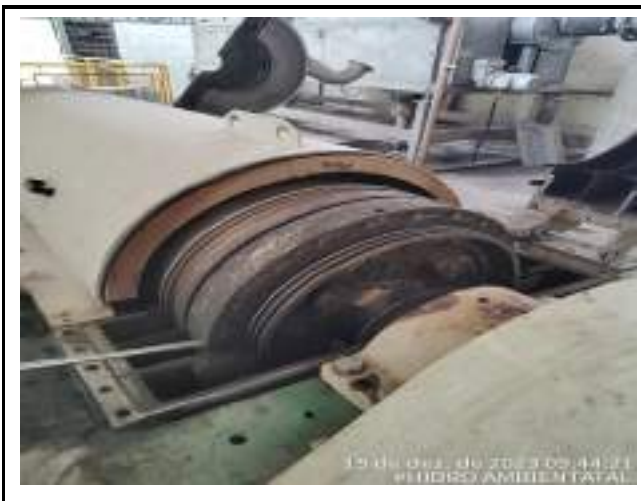
ABERTURA DO DECANTER PARA VERIFICAÇÃO E LIMPEZA
