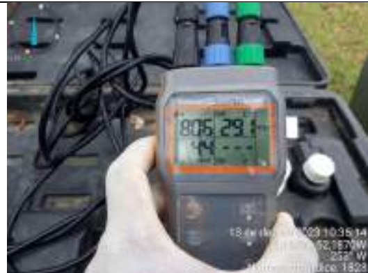
Foto 70: Análise de PH, temperatura, oxigênio dissolvido e Condutividade.
