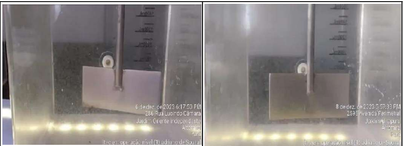
ENSAIOS DE FLOCULAÇÃO COM USO DE APARELHO JAR TEST DA DOSAGEM DO PAC
