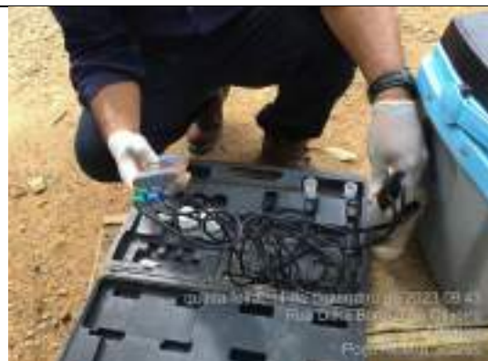
Foto 88: Análise de PH, temperatura, oxigênio dissolvido e Condutividade.
