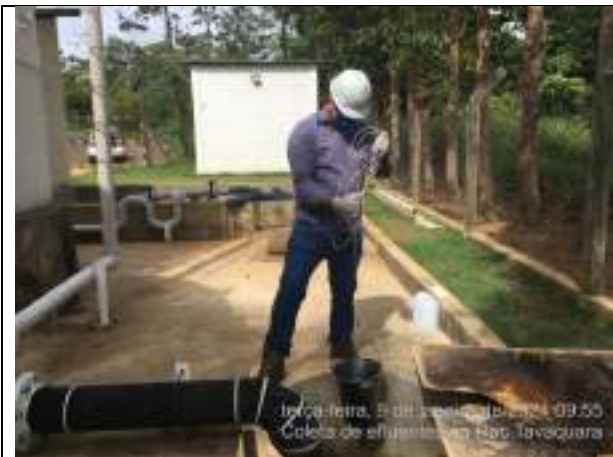
Foto 5: Ponto de coleta – saída do efluente tratado
