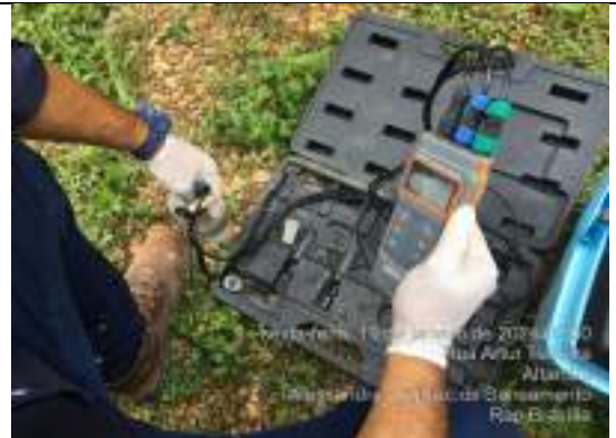
Foto 28: Análise de PH, temperatura, oxigênio dissolvido e Condutividade.
