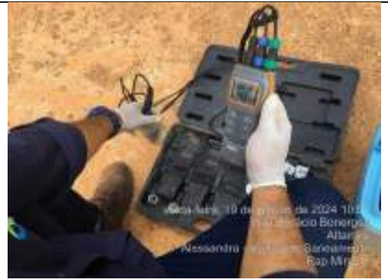
Foto 34: Análise de PH, temperatura, oxigênio dissolvido e Condutividade.
