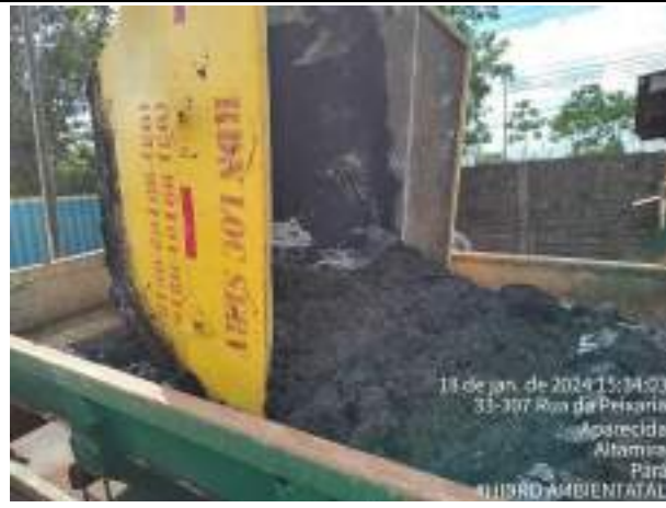
FOI CENTRIFUGADO 16 M 3 DE LODO
