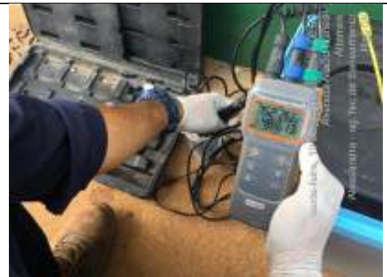
Foto 10: Análise de PH, temperatura, oxigênio dissolvido e Condutividade.
