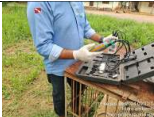
Foto 04: Análise de PH, temperatura, oxigênio dissolvido e Condutividade.
