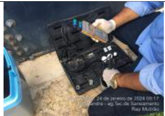
Foto 76: Análise de PH, temperatura, oxigênio dissolvido e Condutividade.
