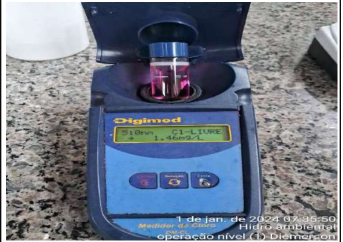
ANÁLISE DOS PARÂMETROS DE TURBIDEZ, CLORO E PH DO RAP 8
