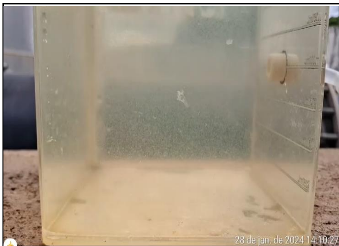
ENSAIOS DE FLOCULAÇÃO COM USO DE APARELHO JAR TEST DA DOSAGEM DO PAC
