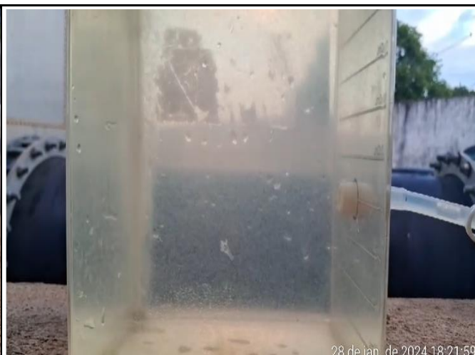
ENSAIOS DE FLOCULAÇÃO COM USO DE APARELHO JAR TEST DA DOSAGEM DO PAC
